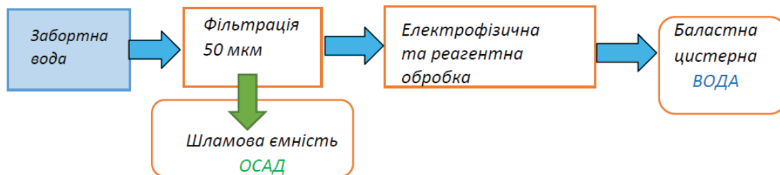
Рисунок 2 – Схема очищення баластної води при її закачуванні до баластних цистерн
