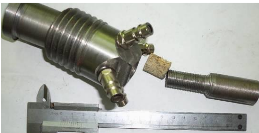
Рисунок 7. Готова збірна одиниця сопла нової конструкції. а – САПР модель збірної одиниці сопла (1 – корпус; 2 - широкий конічний вхід; 3 - пориста циліндричні трубчаста вставка; 4 - вузький довгий конічний вхід); б – реально виготовлена збірна одиниця сопла.
