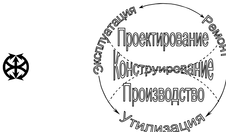
Рисунок 1 – Общая структурная схема жизненного цикла изделия
