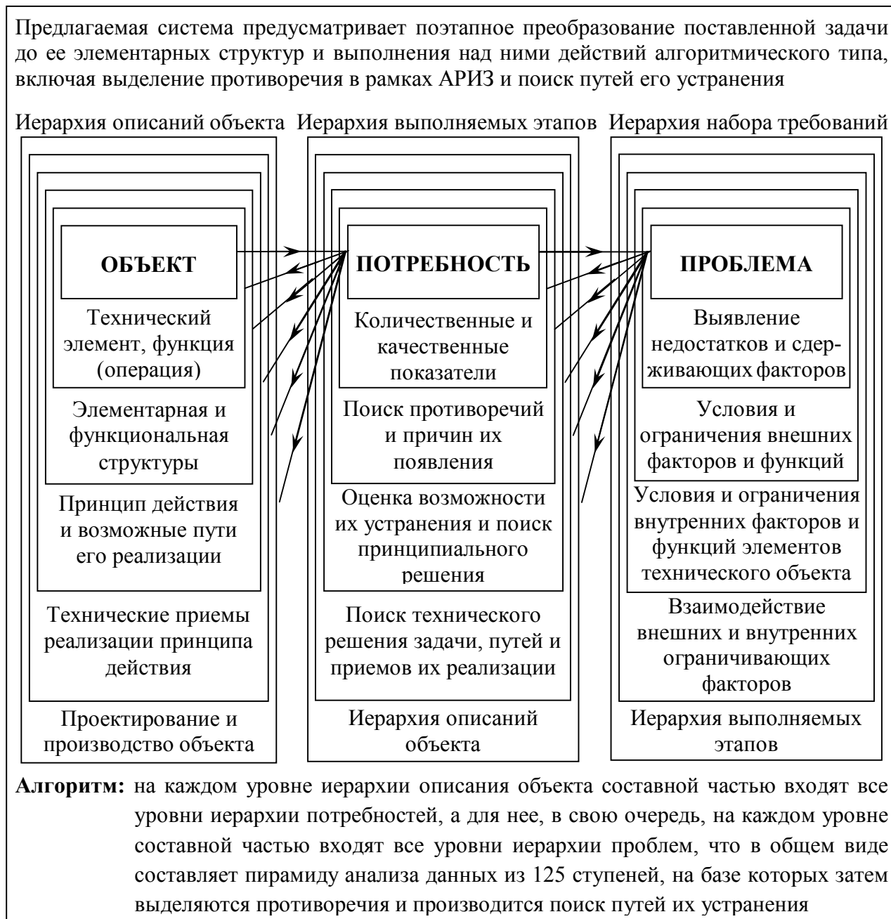
Рисунок 4 – Структурная система для анализа факторов в КОР техники
