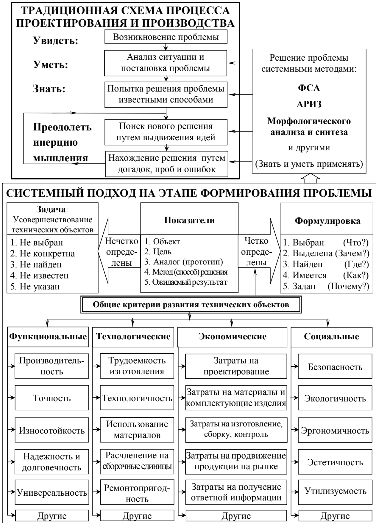
Рисунок 3 – Система исходных этапов и основных факторов процесса комплексно-ориентированной разработки (КОР) техники и технологий
